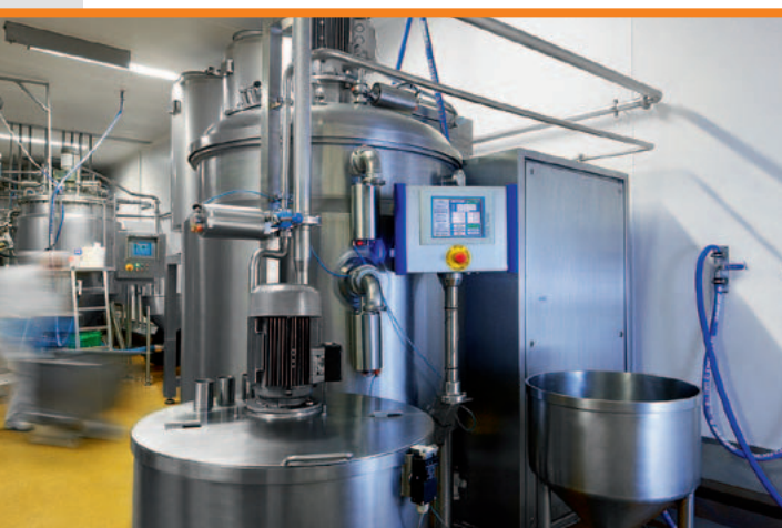
Dispergier-Einheit für die Verarbeitung von Fest-/Flüssigsystemen
