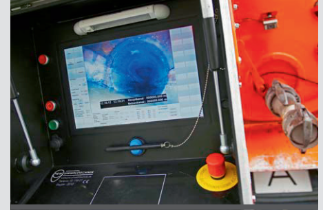
Livestream zwischen Monitor und Kopf des Spülsystems, simultane Steuerung
