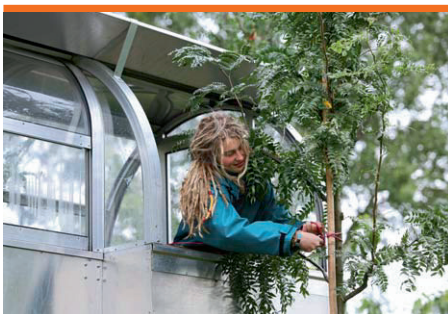
Wetterschutztes, sicheres Arbeiten in 7 Metern Höhe
