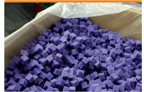
Mit Aktivkohle präparierte Aufwuchsmittel in Würfelform
